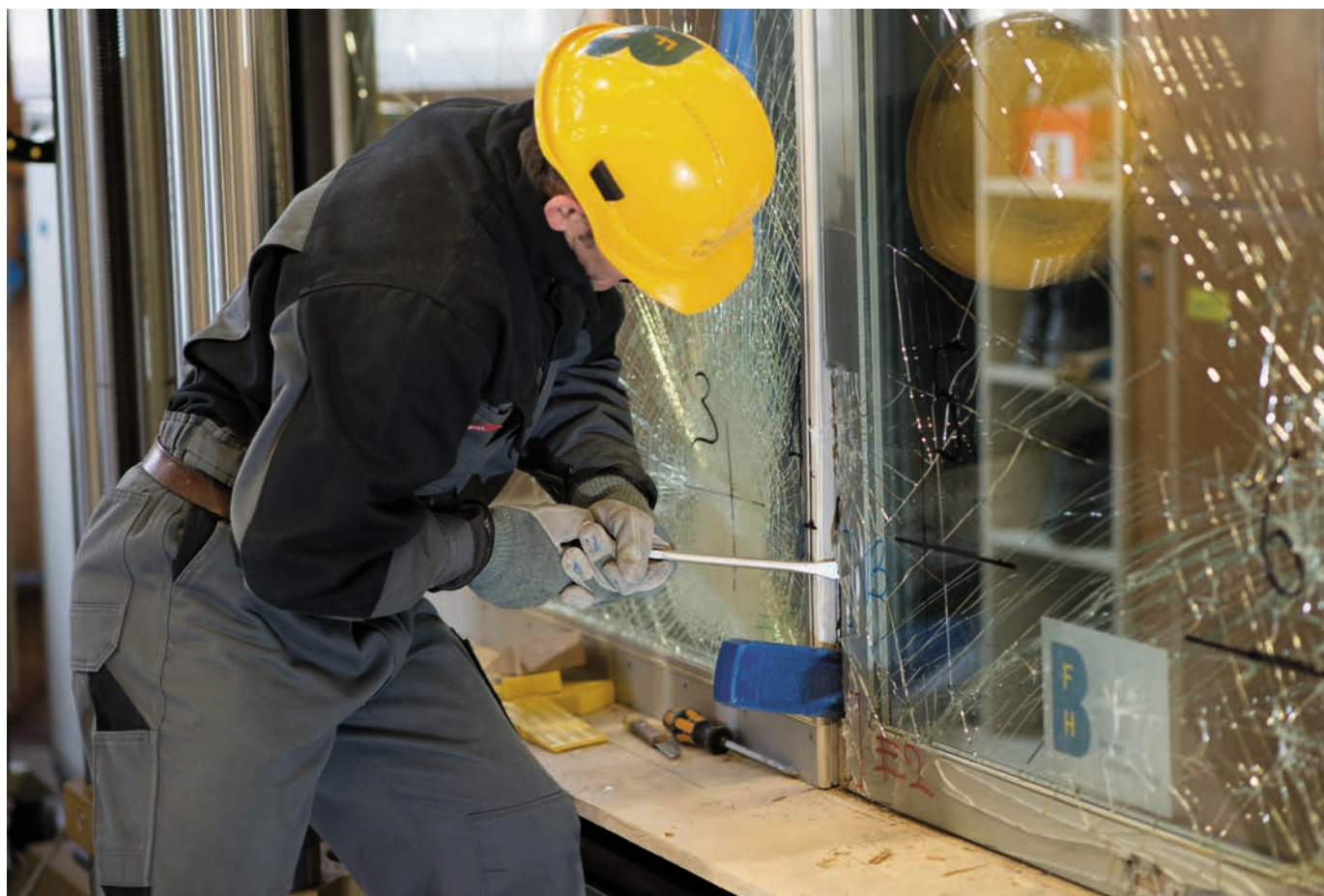
Einbruchprüfung an der Berner Fachhochschule BFH eines Fensters nach RC 2.
