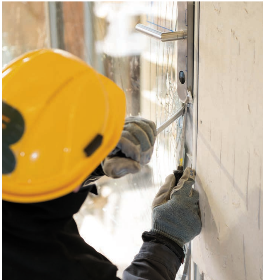
Einbruchprüfung an der Berner Fachhochschule BFH einer Innentüre nach der europäischen Resistance Class 2 (RC 2).
