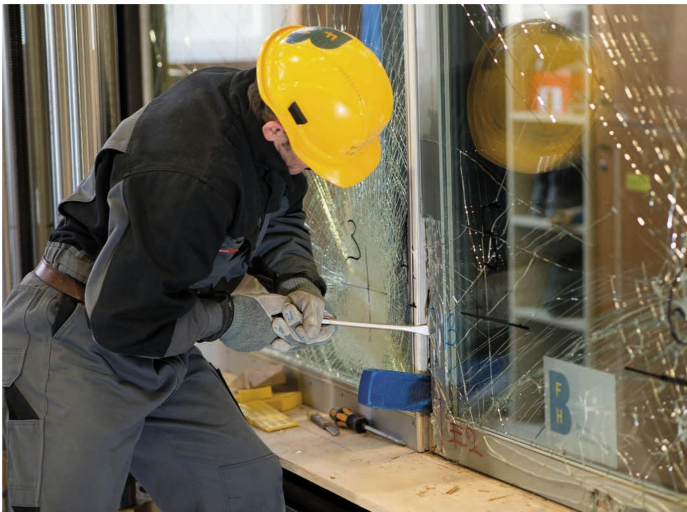
Test anti-effraction RC 2 sur une fenêtre.
