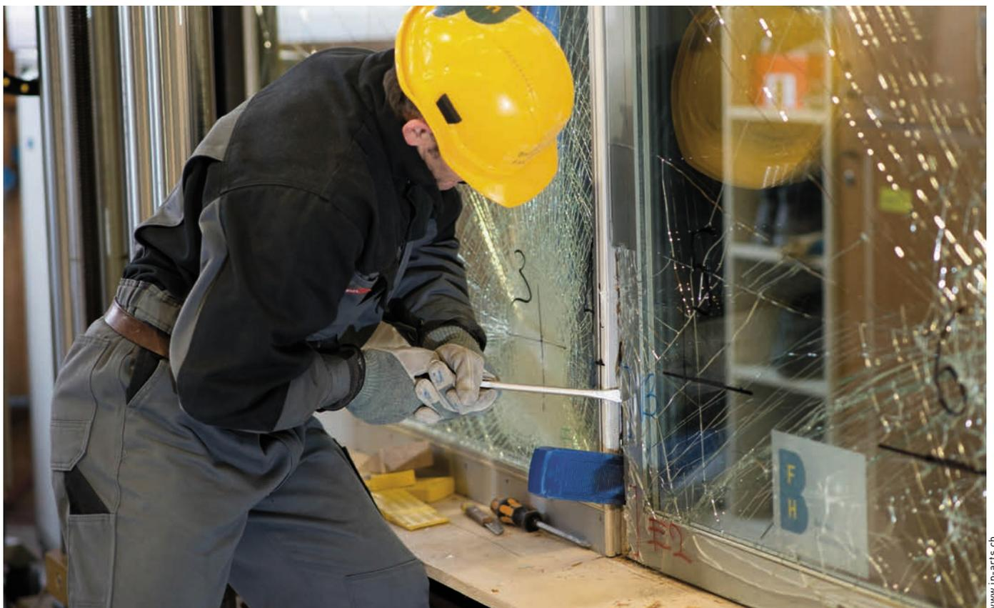
Prova di effrazione di una finestra realizzata conformemente alla classe di resistenza europea 2 (RC 2).
